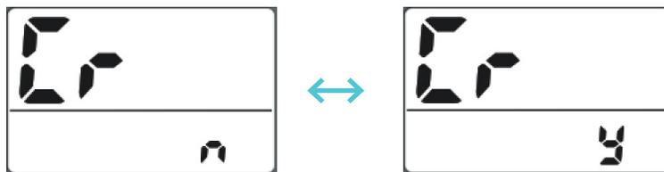
**Système (System) (S7)** : appuyer sur **MODE** pour changer entre le système métrique / impérial.
